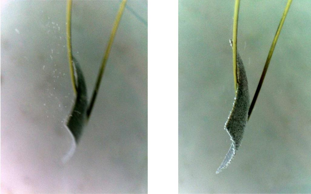
Début d'effervescence à gauche. A droite, la multitude de bulles accumulées sur le Titane, indique la fin de l'anodisation.
