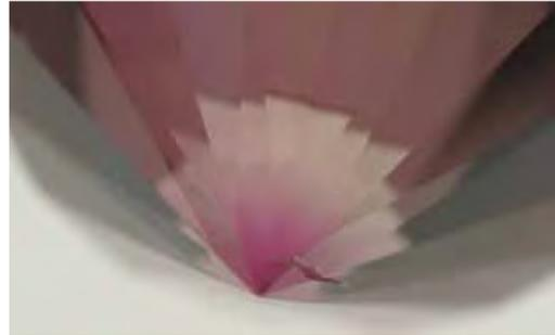
Figure 8 : Culasse d'un diamant irradié par des électrons de basse énergie dans un accélérateur linéaire. La couleur est concentrée sur la pointe de la culasse. Photomicrographie de Wuyi Wang, grossissement 5x [15]
