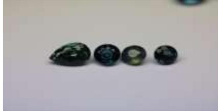
Echantillons N°1-3-5-10 (de gauche à droite sur la photo) utilisés lors des mesures au spectromètre UV-vis. Nous regarderons plus particulièrement les valeurs des courbes dans la partie du spectre visible (400 – 700 nanomètres nm ) ainsi que dans la partie des ultra-violet (UV 300-400nm).
