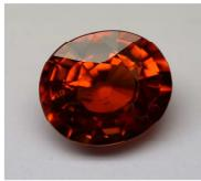
La spessartite rouge orangée (noir) donne 3 fines raies d'absorptions dans le bleu entre 400 et 500 nm. Avec le spectroscopie à main on observe la partie bleue du spectre coupée. Une bande supplémentaire a été observée entre 600 et 700 nm, causée probablement par la présence du chrome.
