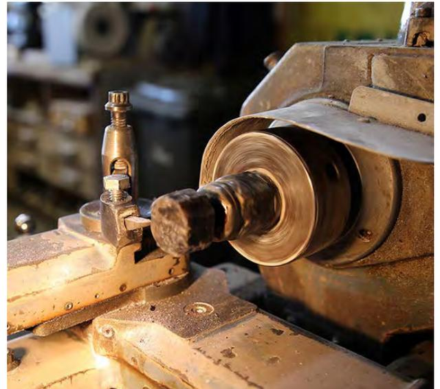
La pierre collée sur le 'dop' est fixée sur la machine. Une lame est placée sur le côté et progressivement, la machine effectue un mouvement rotatif et la lame taille l'extérieur de la pierre. Ceci est le premier stade : on taille la pierre pour qu'elle ait une forme ronde parfaite. L'étape suivante consiste à évider l'intérieur du bol. Pour cela on déplace la lame afin qu'elle soit placée dans l'axe de la pièce pour permettre de creuser le matériau.
