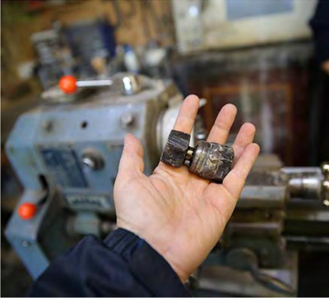
La pierre (préalablement imprégnée) est collée sur le 'dop' qui est spécialement conçu pour être fixé sur la machine. On utilise un mélange spécial (graisse de porc/plâtre de Paris et résine de pin) pour coller la pierre.
