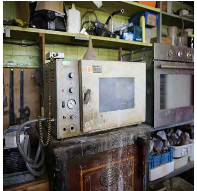
Les pierres sont imprégnées de résine dans un four sous vide à 80°C puis à 40°C et à nouveau à 80°C.
