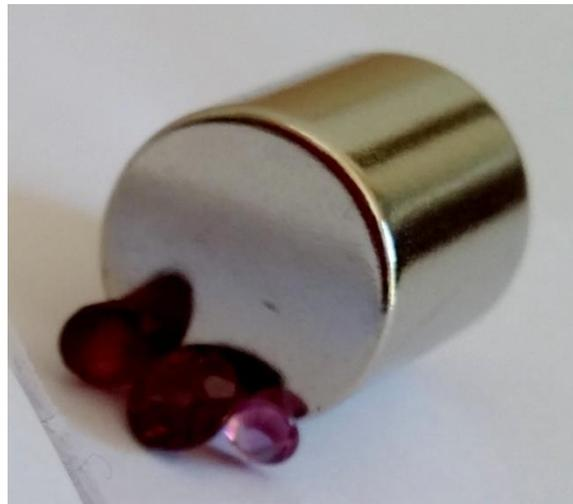
Figure 5-10 : réaction positive d'un grenat rhodolite au test de l'aimant
