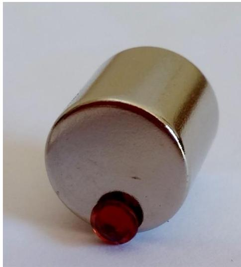
Figure 5-4 : réaction positive d'un grenat pyrope-spessartite au test de l'aimant
