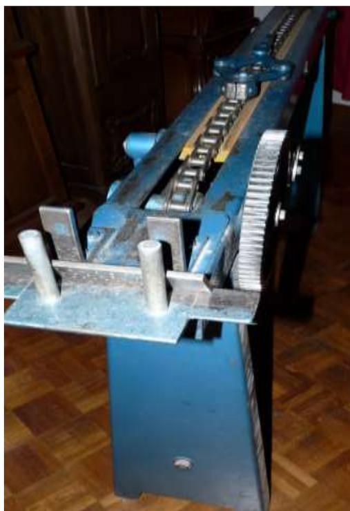
*machine à tirer l'or, encore utilisée de nos jours*
