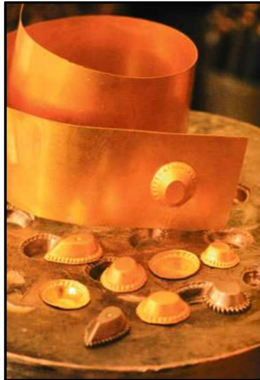
Différents chatons sont fabriqués les uns après les autres pour former le type de bijou choisi. A l'aide d'une lime appelée échoppe, l'artisan fait disparaître à l'intérieur du chaton toute trace de soudure, afin d'éviter que celle-ci n'abîme le grenat montage.
